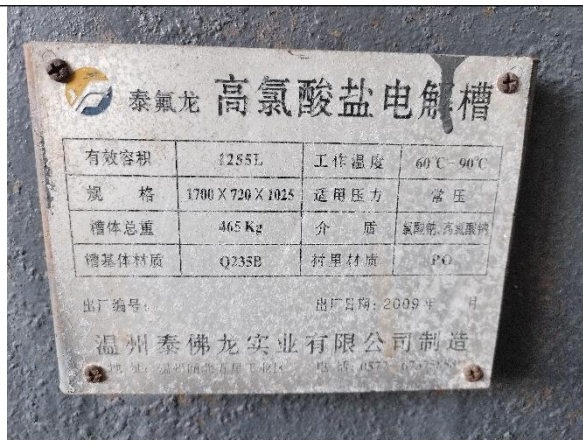
照片 6 电解槽设备铭牌
